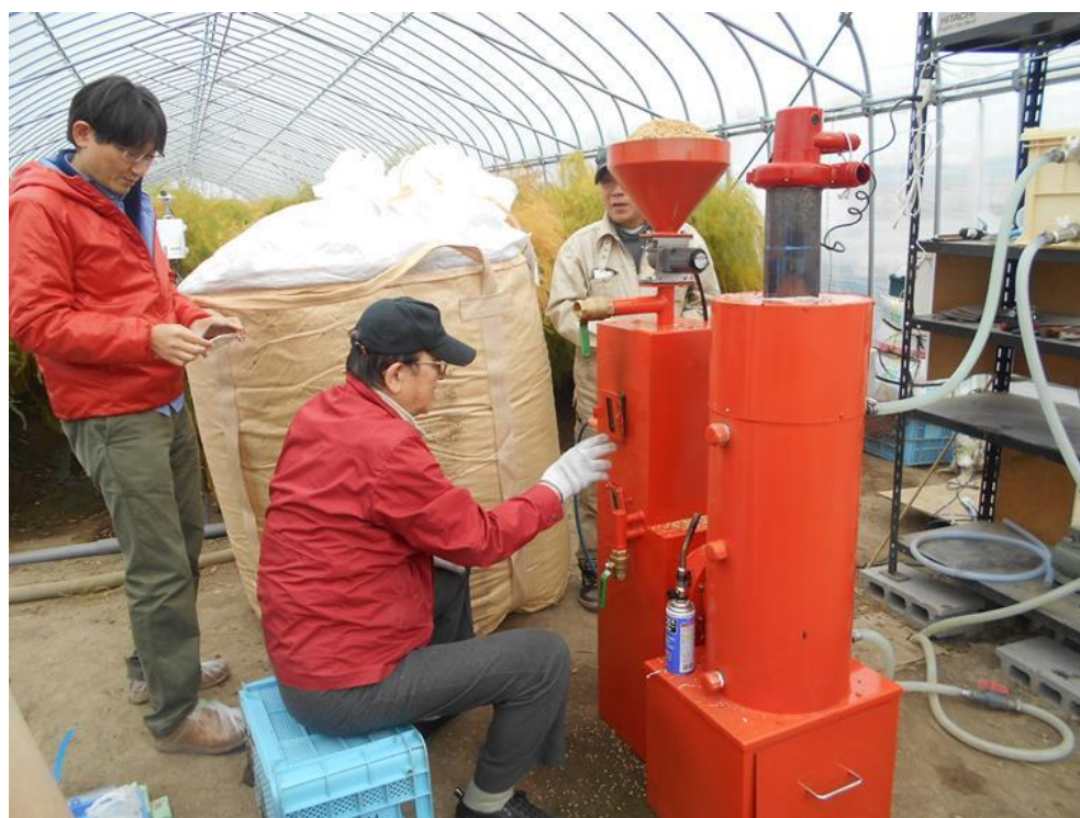
【参考 モミガラ燃焼ボイラー試作機の実証圃場における燃焼実験風景】
